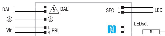
DALI diagram - Collegamento DALI
